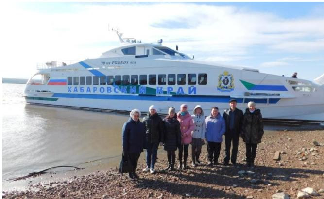
вать теплоход в маловодных направлениях. Работает он на более экологичном дизельном топливе стандарта Евро-5. Главная энергетическая установка лайнера состоит из двух побортных двигателей. Также предусмотрена и вспомогательная система. Быстроходный пассажирский теплоход глиссирующего типа был построен на Хабаровском судостроительном заводе по проекту «А45-2». Он может взять на борт до 100 пассажиров. Длина корабля
